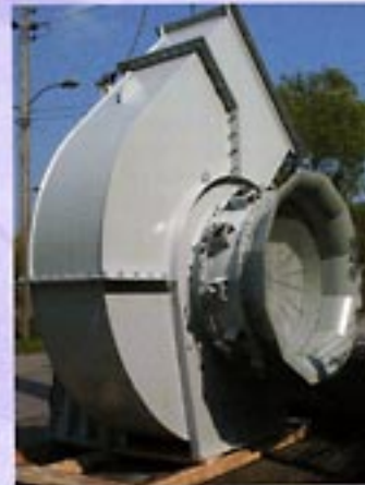
FD Fan with Inlet Piezometer Ring
